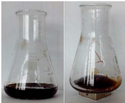
Рис. 1. Слева образец магнитной жидкости без действия магнитного поля, справа – под действием магнитного поля
