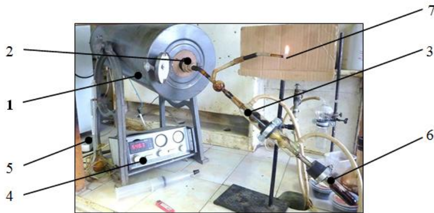
Рис.1. Внешний вид лабораторной установки газификации: 1 – трубчатая печь; 2 – реактор газификации; 3 – система охлаждения и газоочистки; 4 – блок управления; 5 – воздуходувка; 6 – приемная колба для конденсата; 7 – штуцер для отбора проб генераторного газа и его сжигания
